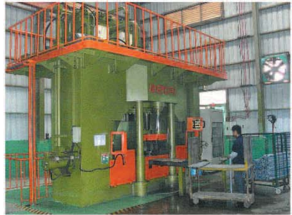
▲逢達聯的液壓管件就是透過機器內壓力，將管材短時間內液壓成型，效率十分驚人。
