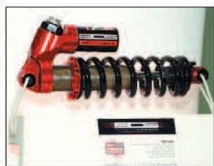
▲BOS最新下坡車用油壓後避震器Story！採一體式儲油槽與三向式閥門設計，高、低壓回彈與壓縮阻尼可調。
