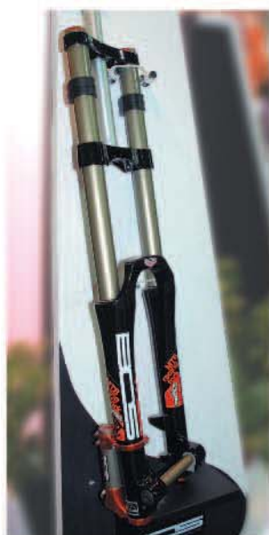
▲BOS令人讚嘆的Idylle Pro下坡車用避震前叉，運用與後避震器相同的技術，採加壓阻止系統、行程200mm、可調式高低壓回彈與壓縮阻尼、7050鋁合金上管（36mm）、鎂合金下管、6061鍛造鋁合金肩蓋。
