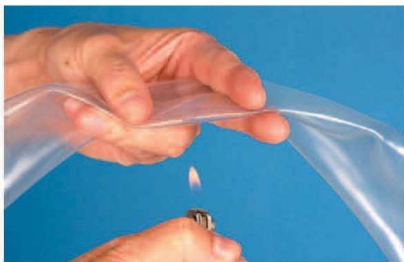
▲只要在距離破胎處1公分於下方以打火機火源畫圈6秒鐘後，再用手捏合使破胎處密合即完成維修。
