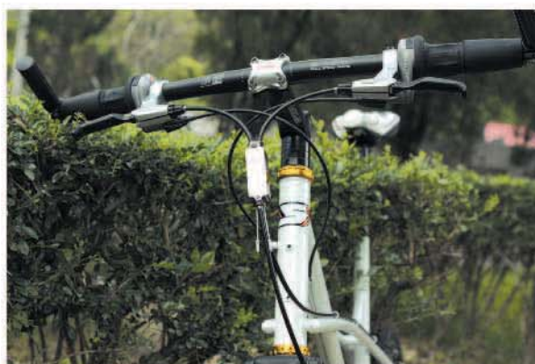
▲便利的 ABM 安全煞車器，亦可裝上小輪徑車。
