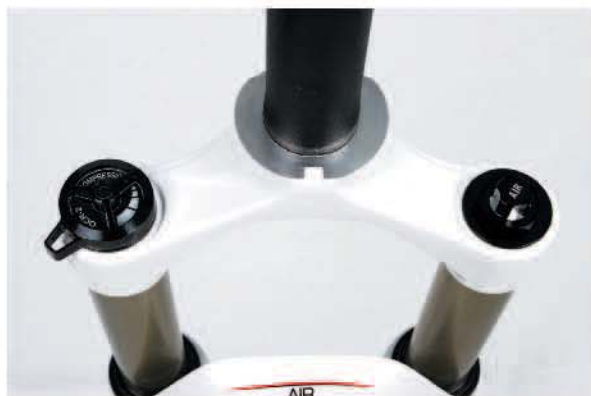
▲09年的F1RST Platinum前叉，左腿採用「氣壓彈簧」作動，右腿採OCR2開放式下壓與回彈可調。
