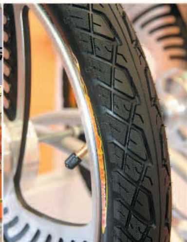
▲正新C1694電動自行車專用胎，有密集加深的紋路設計，能提升耐磨耗性能。
