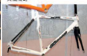
▲卜威510車架採用SPF成型的前三角，搭配輕量化Carbon後上叉及前叉。
