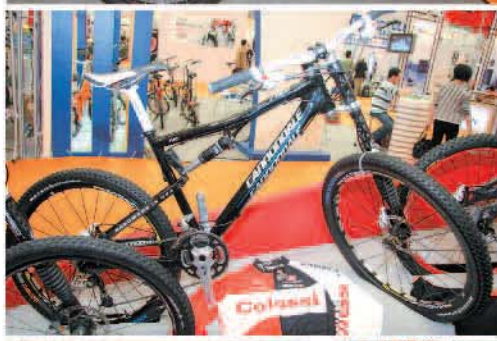
◀ Cannondale 的08年新車 Rize Two， 車架採用鋁 合金結合 Carbon，行程 110-140mm。
