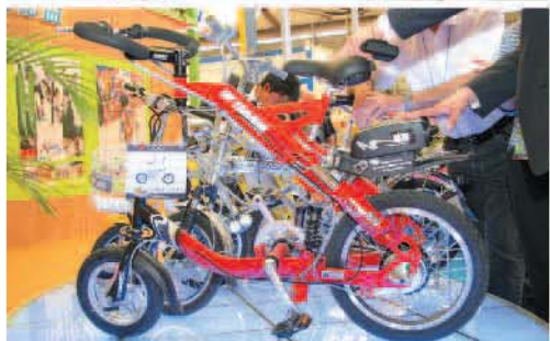
◀ 奧斯電動車探索者二號採用創新的剪刀狀車架，並以鋼絲索與滑輪組成轉向系統。
