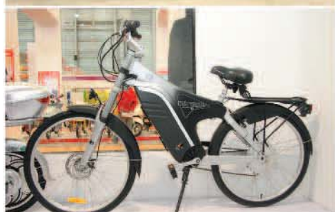
◀美式造型的瑞辰電動車，有前避震及碟煞，能承受劇烈震動，可作為登山車使用。
