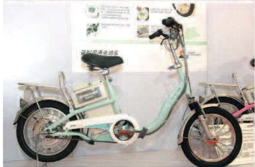
◀ 普利司通電動自行車採用一體式無刷控制器、前後一體式壓鑄鋁合金輪圈，與48V長壽命電池。
