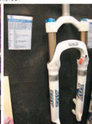
▲Fox 32 F100 RLC前叉使用新的叉體設計和切削鋼件以達到輕量化，重1,530g。
