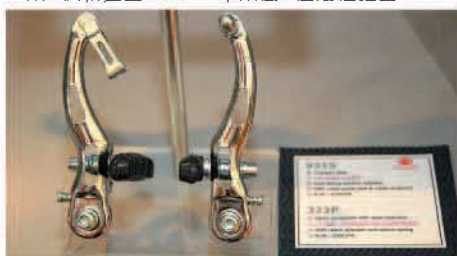
▲Logan展出極度鍍空輕量化的煞車夾器。
