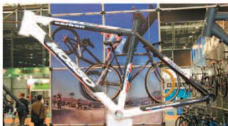
▲MOSSO展示其以Carbon包層鋁合金的專利車架，價格比全Carbon車架低，但剛性更佳。
