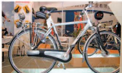
▲荷蘭原裝進口的鹿頭城市車，採用輕巧內變七速系統，前輪、座墊雙避震。
