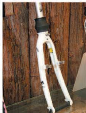
▲凱薩克A5避震前叉適用於20英吋的城市折疊車或小跑車，V夾、碟煞都可用。
