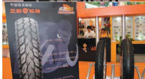
▲正新C1694電動自行車專用胎，有密集加深的紋路設計，能提升耐磨耗性能。
