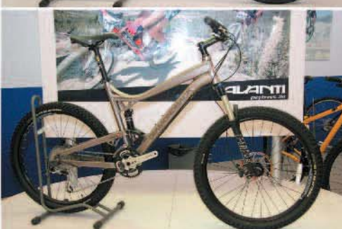
◀美式造型的瑞辰電動車，有前避震及碟煞，能承受劇烈震動，可作為登山車使用。
