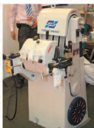
▲捷鋒四帶圓管研磨機，能經由四條粗細不同砂帶一次研磨完成。
