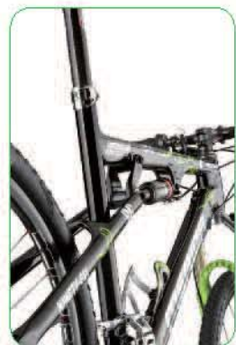
▲採用多連桿避震系統與特製後避震器。
