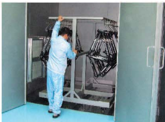
▲力爾引進的專業用烤箱，能將車架上多餘的水分與漆料烘乾，節省製作時間。
