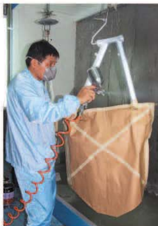
▲力爾要求烤漆時一律穿戴無塵衣與口罩，將車架沾染灰塵的可能性降到最低。
