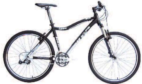
▲ Dorcus 相當受歡迎的「海豚車」，車架使用 6069 鋁合金材質，經過七道拋光手續，上管的弧度設計能減少騎乘時的應力集中。
