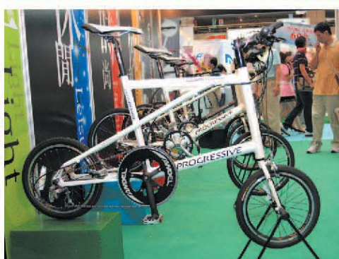
▲ Progressive 16吋小輪徑車，採用特殊的66T大盤，適合騎乘城市平路及緩坡，由日本設計，台灣美優製造。
