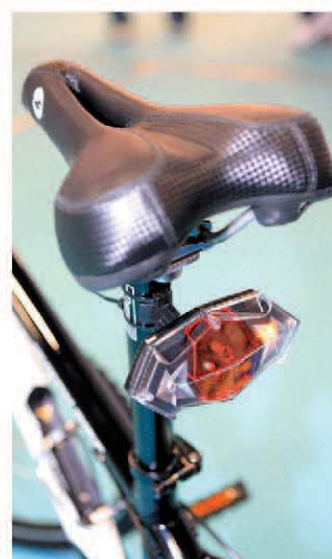
▲品量推出無線控制方向燈，擁有方向指示、路旁停車警示等多功能，並使用可充式鋰電池。
