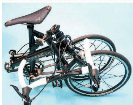
▲有圖Speed One折疊車採用水滴型中管補強，有貼心的收納卡榫，收折後搬動也不會散開。
