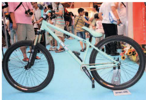
▲ Bear's Bike 推出獨特的左駕表演車，齒盤在車身左側，並可完全客製化。
