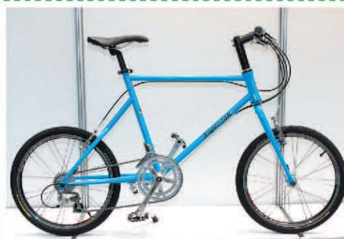
▲ 吉安Super JAB小輪徑鋼管跑車，採用Shimano Sora 18段變速，參考售價NT$13,500。
