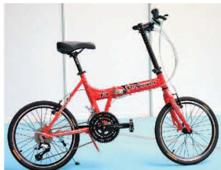
▲Leapower採用跑車大齒盤(30/52T) 搭配登山車飛輪(11/34T)，僅重10.5kg，參考售價NT$18,000。
