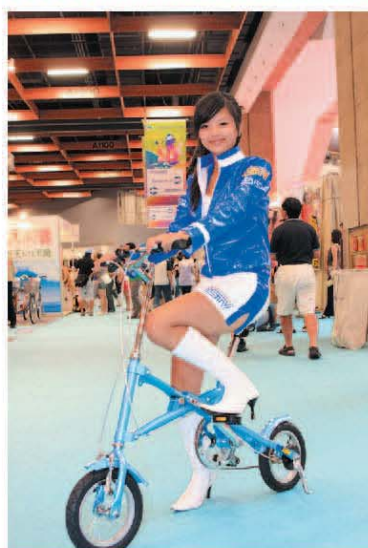
▲ 見發EZ-Link易聯車，快速收展一秒ok，採用高碳鋼與鋁合金材質，重12.9kg。
