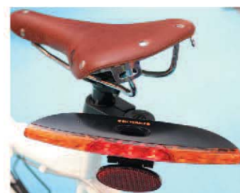
▲百宏益無線控制自行車方向燈，由把手的開關控制鈕，即可無線控制前後方的方向燈。
