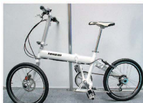
▲ 瑪露洲TAKUMI折疊車改變頭管折疊機構的角度，搭配單邊前後叉設計，大幅降低折疊後的寬度。
