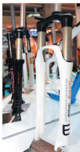
▲榮翰Epicon前叉，底管為鋁合金，前叉管鋁合金，行程100mm，重1.82kg，適用於XC、All-Mountain。
