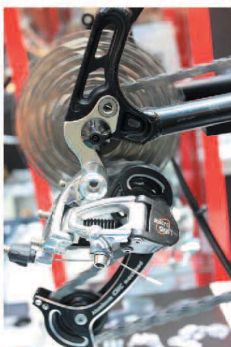
▲台灣微轉所推出的新款後變速器，能一次變7速。
