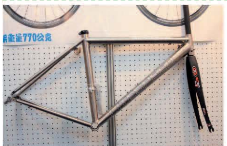
▲ Litespeed 鈦合金車架組，車架僅重 770g，搭配 Easton 前叉。
