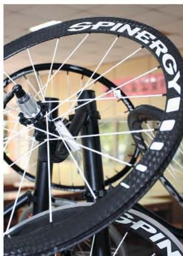
▲Spinergy公路車專用43mm輕量化碳纖維輪組，採用PBO纖維輪條，重1,390g。
