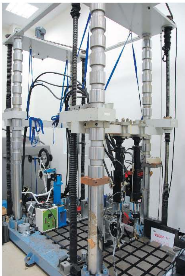
▲疲勞試驗是EN法規中相當嚴苛的一項測試，SGS使用美國MTS油壓疲勞試驗機，能準確控制頻率的設定、施力的精準度及位移量。
