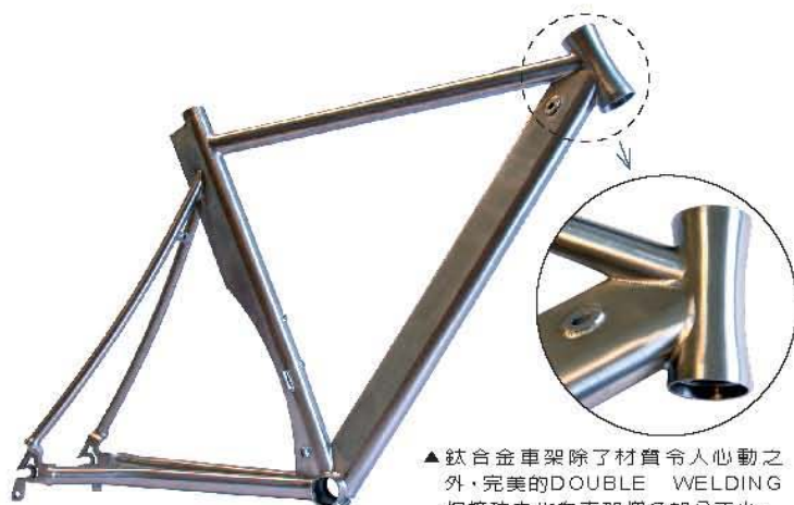
▲一根鈦合金管材擁有兩端孔徑不同的尺寸與造型，是德瑞斯技術的保證。
