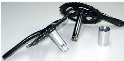
◀此圖可以明顯看出BB30曲柄齒盤組的中軸（左）比傳統的中軸（右）更粗，也比較短。
