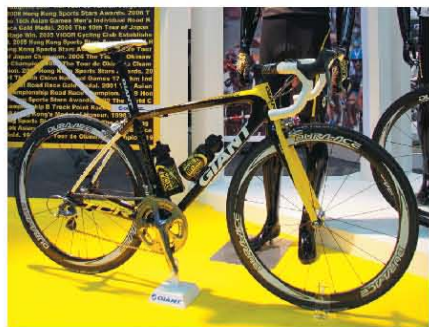
◀ Giant 的 Road to Beijing 車款，也是採用加寬車架五通、將培林碗組內置的設計，所配合使用的大盤組依然是 24mm 的中軸。
