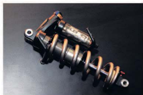
▲X-Fusion Vector HLR的避震作動高低速可調，M5材質的外筒蓋除了減輕重量，更比6系列鋁合金材質提高12%的強度。
