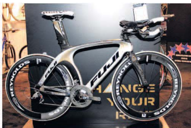
▲FUJI D-6 Professional三鐵車的車架、前叉、drivetrain以及輪組都是碳纖維材質。
