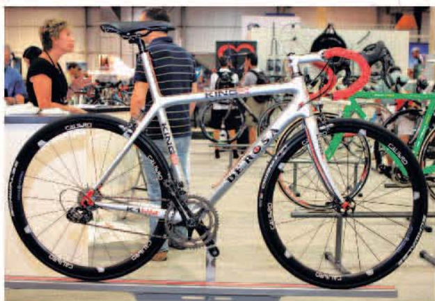
▲De Rosa King 3一體式車架搭配Campagnolo最新Super Record 11速變速套件。
