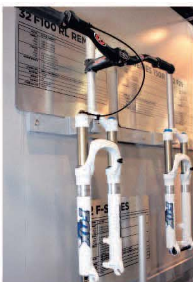
▲FOX 32 F100RL前叉可用線控調整Lockout功能，行程為3.9吋 (100mm)。
