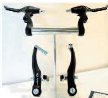
▲鐘贏Logan推出鋁合金材質佐以碳纖維塗裝的煞車夾器。
