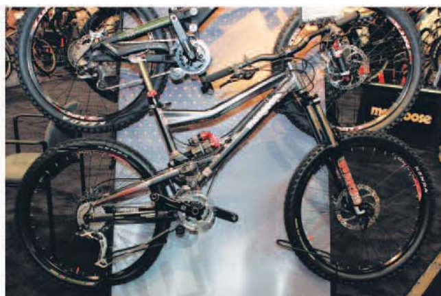
▲Mongoose Khyber雙避震車，行程為6.5吋，並配有Kind Shock線控可調式避震座管。
