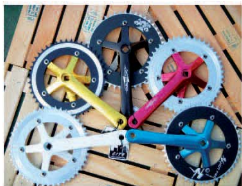
▲LASCO展出了美國最當紅的單速車專用大齒盤，為鋁合金拋光陽極處理，提供多樣色彩選擇，滿足客戶的需求。
