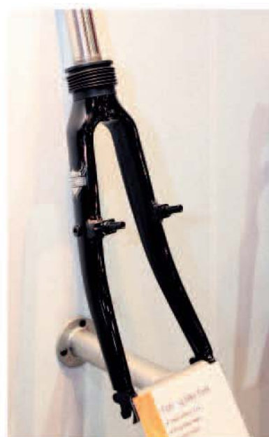
▲Spinner針對折疊車修補市場推出小折前叉，可改裝為碟煞用，重800g。
