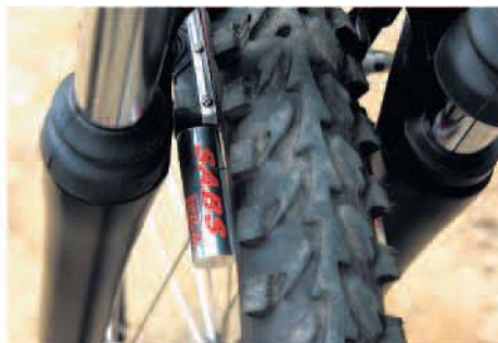
▲相較於一般煞車塊，SABS煞車塊由於多出一個缸體，裝配時須考慮前叉、後上叉與輪圈之間的距離是否足夠。
