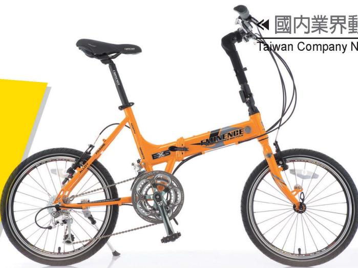
目前主打的折疊車EX5，主要考量為其騎乘性能、舒適性與安全性，因此在設計車架幾何時，特別注重其爬坡功能，另外也改變把手立管的角度，讓小折車在上下坡時也能增進其穩定性。並在車身折疊後的接觸處加裝了固定磁鐵，使得車身在折疊後，不會互相碰撞或分開，還能推著走，大大增加折疊後移動的便利性。
