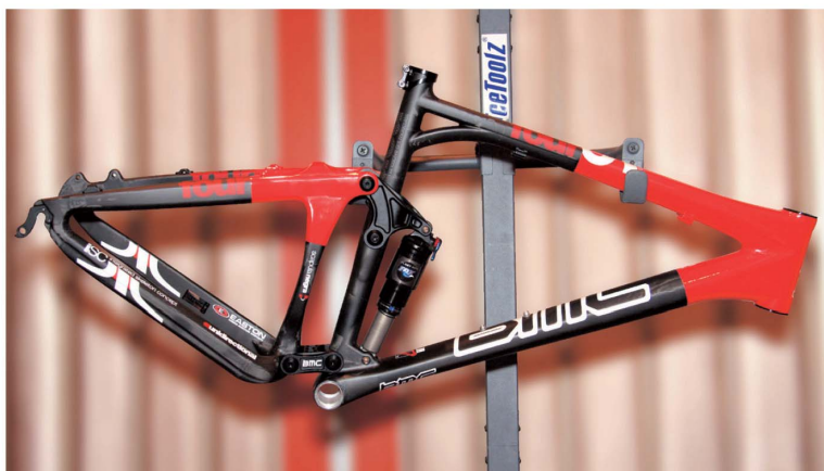
▲採虛擬轉點的Fourstroke FS01避震車架為全碳纖維材質，同時也有整車引進。
