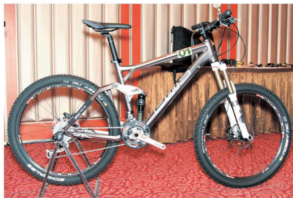
▲Trailfox TF01車架為鋁合金材質，並運用triple butted三層抽管技術，讓整車重量降到12.6kg。
