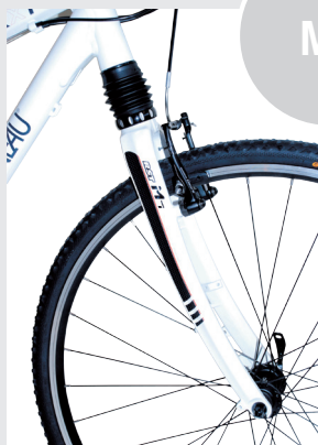
◀ 針對 700C 輪徑登山車設計的鎂合金單槍式前叉 M7，外觀高雅流線，避震行程 40mm。
