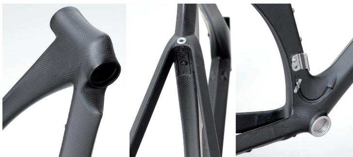
▲▶採用航太低風阻流線成型科技的碳纖維車架。
