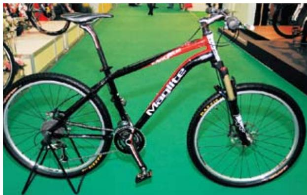
▲達富全新車架採用鎂合金，整車僅重9.3kg。
