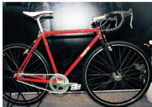
▲來自日本的Toyo只生產純手工焊接的鋼管車架，圖為其鋼管單速車產品。
