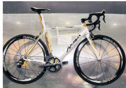
▲明係AXMAN公路車內導線設計外觀乾淨俐落，採用水滴型座管，前三角一體成型，造型流線，可降低風阻。
