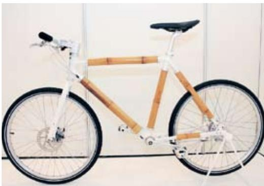
▲由愛爾蘭商代理的Biomega，展出竹製車架，採用傳動軸加內變速，強調美觀實用的北歐風格。
