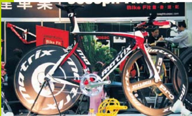
▲成達Matrix的公路計時賽車，採用全Carbon一體成型車架。
