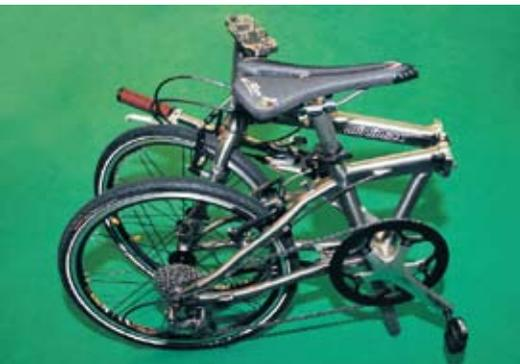
▲恆豐展出Minimax以全鈦打造的小徑折疊車，搭配Dura Ace變速系統，重8.4kg，要價NT\$115,000。
