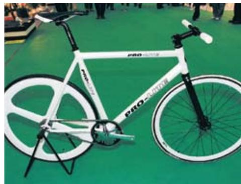
▲Pro-Lite忠於單速車原始的簡單風格，採用平把及五刀輪，車架以機翼概念設計。
