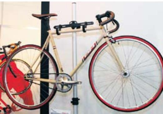
▲BH Gira單速車可變換Single speed或Fixed-gear使用，採Reynold 525管材，重9kg。
