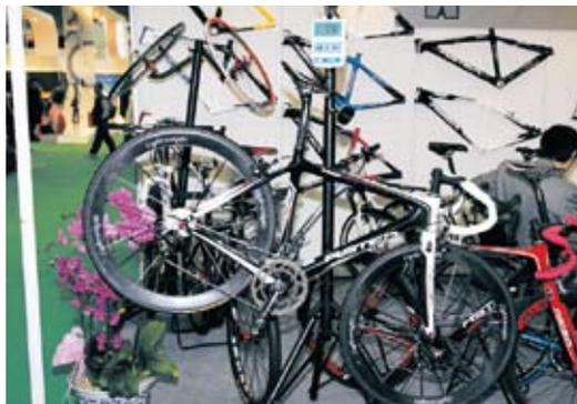
▲亞仕大ASTER碳纖公路車，專利工字肋骨結構設計，可分散應力進而達到質輕及絕佳的剛性強度，全車僅重5.78kg。
