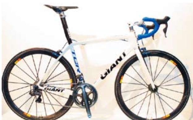
▲Giant全球限量161台的Advance SL，採用Shimano電子式變速器，導線內藏以保護電子系統。
