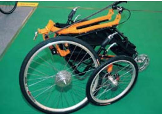
▲標豐新開發的折疊斜躺車，不需拆卸座椅即可輕易收納。
