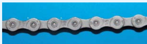
▲桂盟KMC的Z99RB鏈條為9速使用，採用StretchProof Mushroomed Pin。
