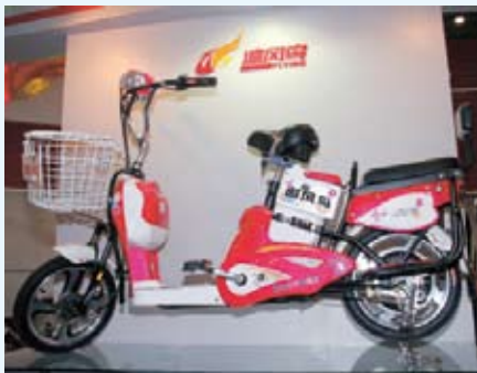
▲追風鳥展出的電動車有故障自檢系統，消費者可依燈號不同判斷故障來源。
