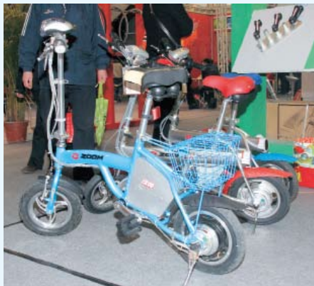
▲信隆太倉Zoom瑞姆電動車TDU-980Z使用鋁鎂合金車架，強調輕盈，鋰電池也經久耐用。
