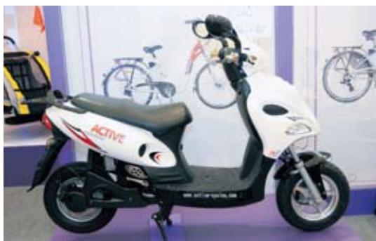
▲耀馬的豪華型電動摩托車採用鉛酸電池、重85kg、前後碟煞。
