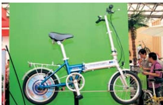
▲XDS喜德盛的折疊式電動車BIC，將鋰電池內置在車架上管。
