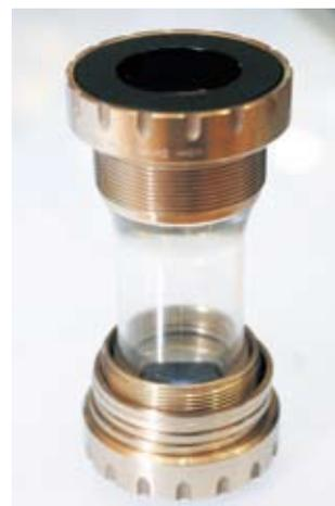
▲誌慶的BB採用陶瓷軸承，潤滑度大幅上升。
