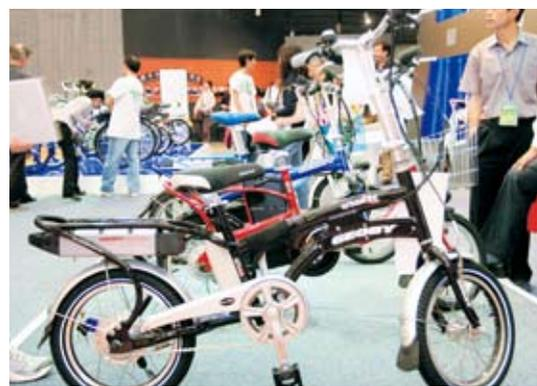
▲捷奧比推出專利16吋電動折疊車，採用鋰電，有雙重安全折疊結構，不含電池20kg。
