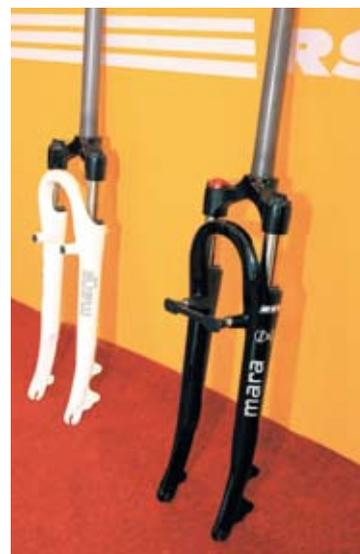
▲RST電動車專用前叉mara，鎂合金外管、線控鎖死，行程40mm。
