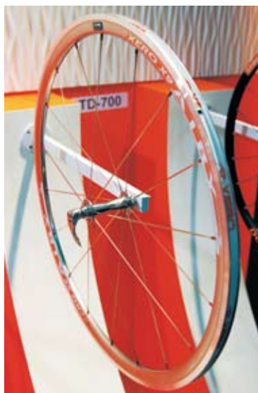
▲鑫元鴻的鋁合金輪組強調高慣性，棘輪定位系統和快拆定位系統偏心軸，重量1,440g。
