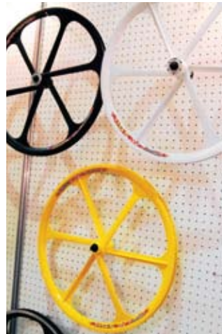
▲田霖分離式的輪殼與輪鼓，讓不同車款的車胎可通用。
