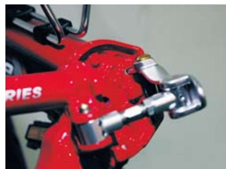
▲申羽一體式流線造型的盒體，強化包覆外觀，而盒體內側具有增加抗扭之新設計。
