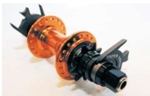
▲單速車的水平勾爪使得後輪有鬆脫的疑慮，因此廖武雄開發出利用斜槽來固定的Taper Lock。
