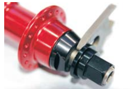
▲喬紳TAPER LOCK設計，可保護培林或避免崩牙。
