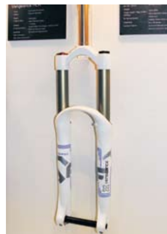
▲野寶X-Fusion Vengeance HLR前叉有高低速兩段式Compression、阻尼可調等功能，行程160mm，重2.22kg。
