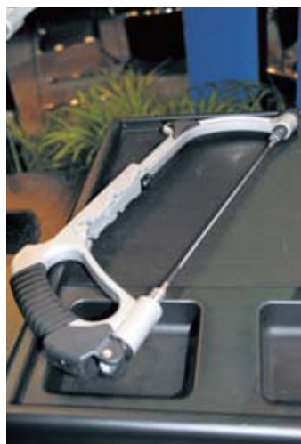
▲保忠SuperB鋁鋁鋸為碳纖維專用，裁切Carbon管材可保斷面無撕裂鋸痕，適合車店使用。
