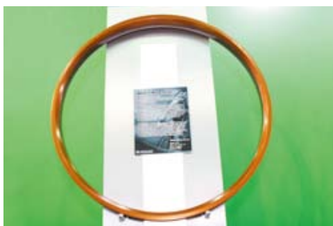
▲ 錦麟KINLIN結合鋁合金與不鏽鋼的pin，做到寬43mm的DH輪圈，強度更足。
