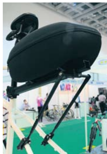
▲去年將貨架裝在座桿與後上叉，突破傳統後貨架受限於後輪與後三角的設計，小徑車、避震車都能用。
