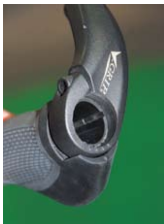
▲辰驛ER1人體工學手握，有4個定位點避免左右調整不對稱，材質為超輕鋁合金，單支重55g。
