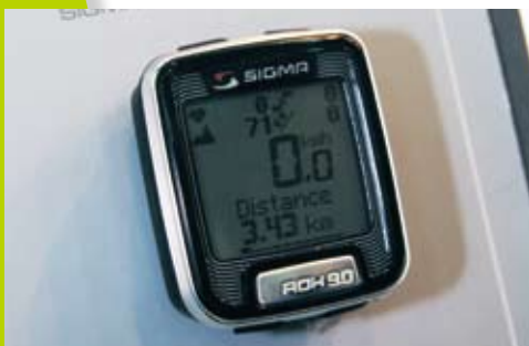
▲SIGMA RDX 9.0自行車心跳表有三無線的碼表、心跳表和迴轉數功能，騎乘中所需的資訊一應俱全。
