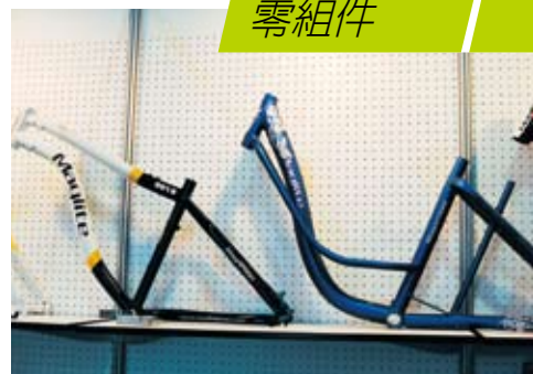
▲偉輪利用鎂合金材質製成的車架，具備吸震和環保優點，並利用奈米技術克服腐蝕問題。
