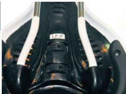
▲美而光i-flex plus座墊下方有一可調彈片，調整座墊軟硬，皮面座墊不用釘合，並使用高週波壓花。
