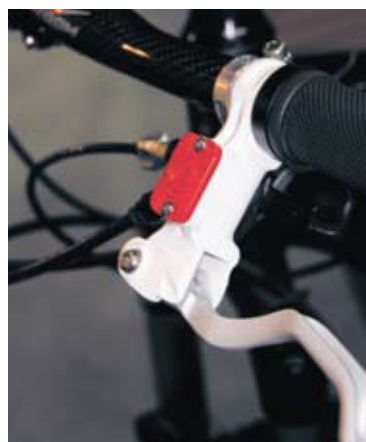
▲信隆Zoom 850油壓碟煞率先在烤漆時引用鐵氟龍技術，不沾特性便於清理，並延長使用壽命。
