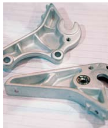
▲精確將鋁合金車架的後勾爪採用減重設計，有效減重至少50%。
