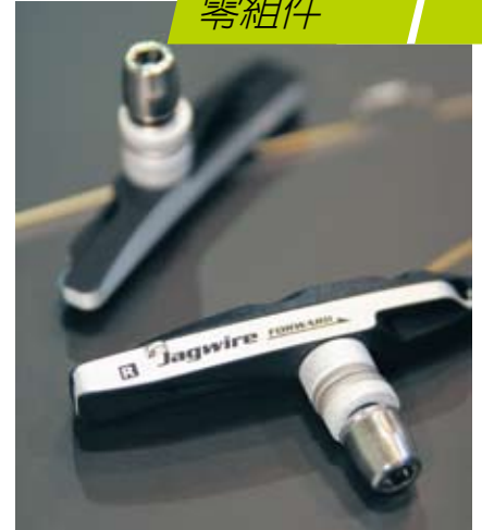
▲佳承的登山車煞車皮採風洞設計，可有效降溫。
