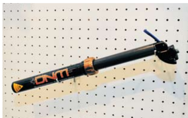
▲DNM推出無段可調避震座桿，130mm行程，可線控調整。
