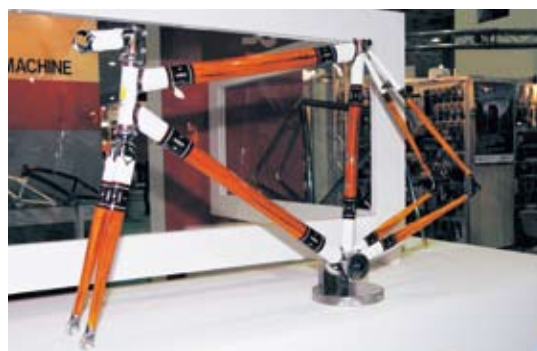
▲永久高級手工鋼管車架，陽極個人耀眼風格塗裝，做工精細堅實耐用。
