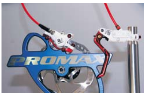
▲利奇Promax最新油壓碟煞組採2 Piece組裝，可隔絕空氣、避免漏油。
