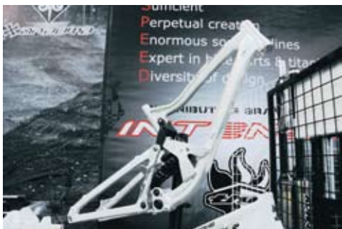
▲家豐榮DaBomb最新避震車架，上細（1.125吋）下粗（1.5吋）的葫蘆型頭管。
