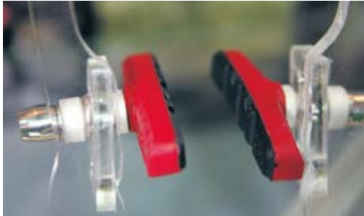
▲弘家使用兩種顏色的煞車皮，可便於提醒消費者更換時機。
