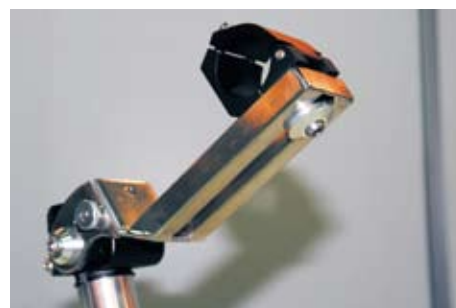
▲駿鎰Right-Hand Tool量測工具，用來測量車手最適合的豎管長度，免去重複拆裝車把浪費的時間。
