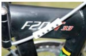
◀管線車架保護套，能避免磨損車架，還有美觀的功能。
