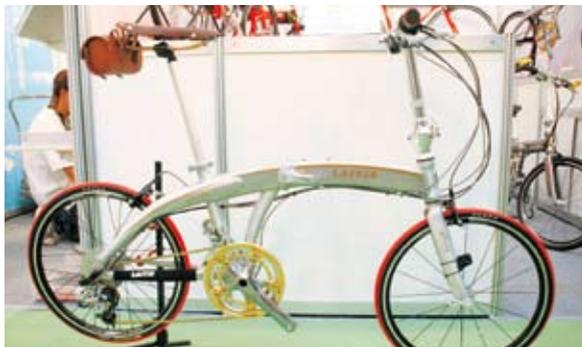
▲帝霸Laitis L3折疊車為拱型車架，外型流線，搭配內變速X.0 11-34T，整體變速高達54段。
