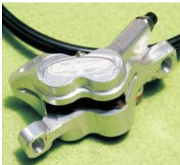
▲Hope雙活塞碟煞組的卡鉗使用整顆鋁塊作CNC，外型質感更佳；撥桿鏤空設計不只防滑、手感也更好。
