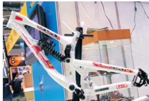
▲▲以美國下坡賽道命名的Intense下坡車架，Easton EA6X手工焊接管材，剛性增30%、重量減15%，後勾爪與避震器各有2孔位可調。
