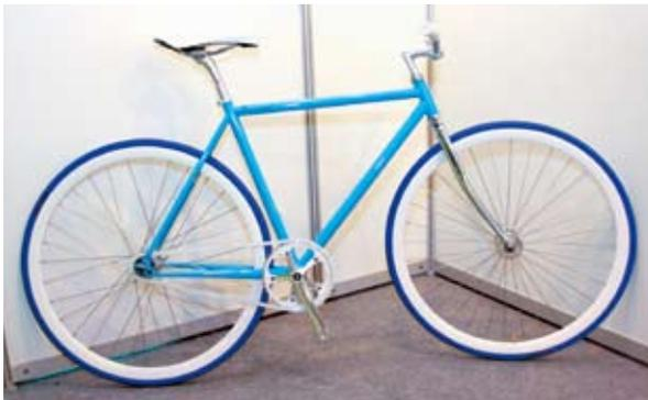
◀Bronco單速車，採用Cr-Mo材質車架，塗裝全以藍、白搭配，充滿街頭風，Fixed-Gear與單速兩用。
