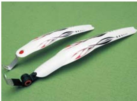
▲辰驊One Touch可拆卸前後土除，無須工具，只須按壓橋環即可輕鬆從橋管拆下。
