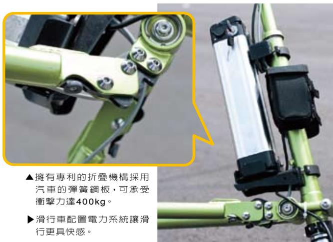
▲擁有專利的折疊機構採用汽車的彈簧鋼板，可承受衝擊力達 400kg。
