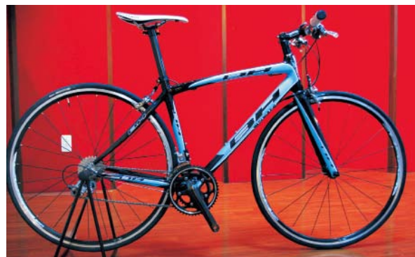
◀▼G5採用BB30規格，車架有72.5-73度較後傾的中管幾何與低風阻、輕量化設計的水滴型、一體式座管。
