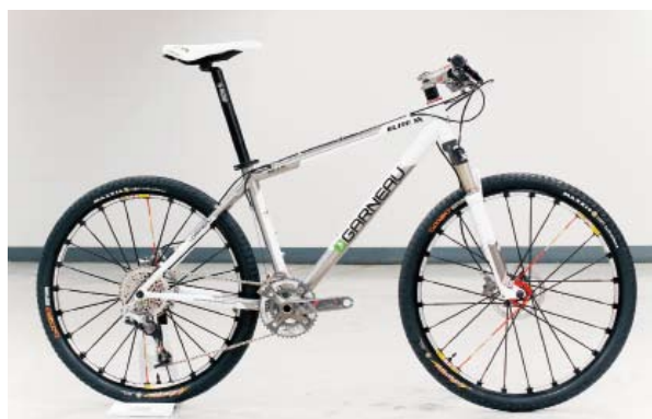
▲走高檔路線的ELITE XX使用鈦合金車架，搭配最新SRAM XX，整車9kg。
