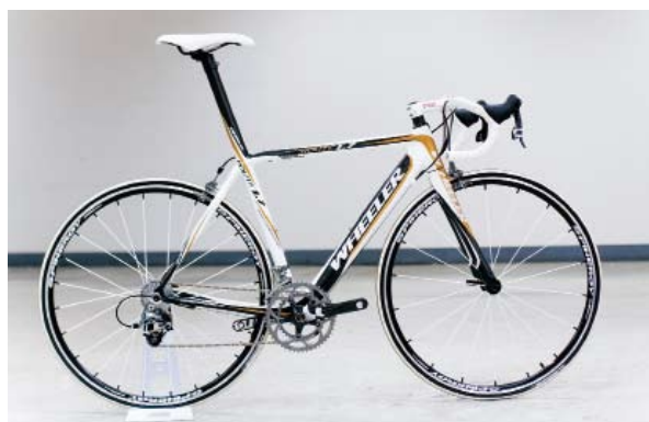
▲ROUTE1.7為競賽級的公路跑車，以ISP一體式座管及異型管車架減低風阻達到輕量化，重量6.7kg。
