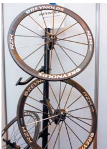
▲Reynolds R2R採用碳纖維材質與特殊編織方式，即便每組重量低於900g，卻能創造出強而有力的剛性。
