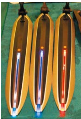
▲V-GRIP在泥除上加入一顆LED，配合導光式設計，方便集中光源；共有三種變化模式，三種顏色可選擇。
