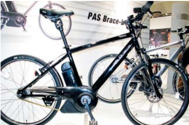
▲Yamaha Brace-L Special電動輔助自行車，搭載PAS系統、內八段變速、鋰電池、240W、充電四小時，全車重23.1kg。
