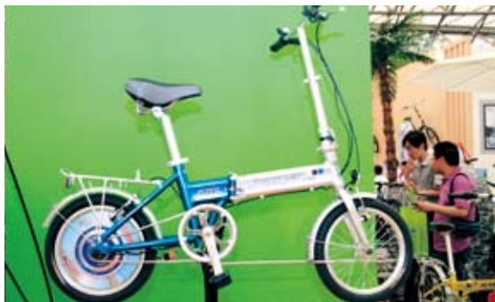
▲XDS喜德盛的折疊式電動車BIC，將鋰電池內置在車架上管。
