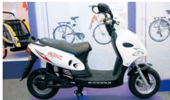
▲羅馬的豪華型電動摩托車採用鉛酸電池、重85kg、前後碟煞。
