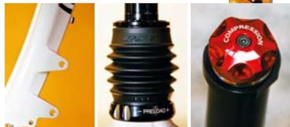
▲ 利用一體成型無焊道的作工技術，所預留的碟煞座孔。
