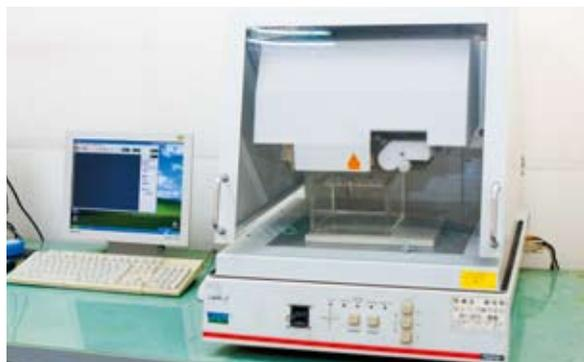
▲透過X-ray膜度測試機，Bossard工程師可確認材質的正確性與電鍍層的防鏽能力。
