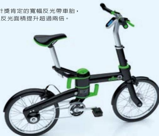
▲東庚展出顛覆傳統想像的創新折疊電動自行車db0，採鋁合金一體成型射出技術車架，流線美觀，搭配單臂前叉與後叉，加上皮帶傳動、內三速與精巧鋰電池，續航力達80km。
