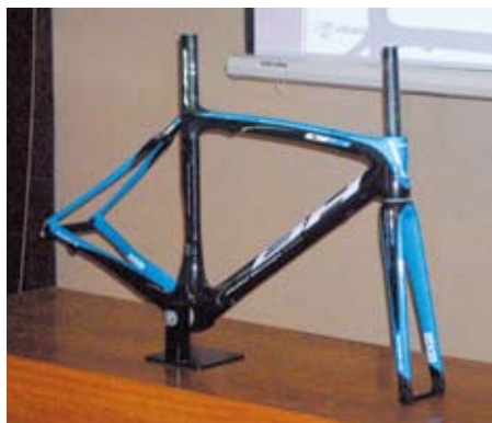
◀BH G5的車架應用奈米碳纖維科技，在不增加重量下，強化管材強度。
