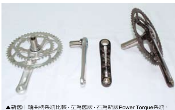
▲新舊中軸曲柄系統比較，左為舊版，右為新版Power Torque系統。
