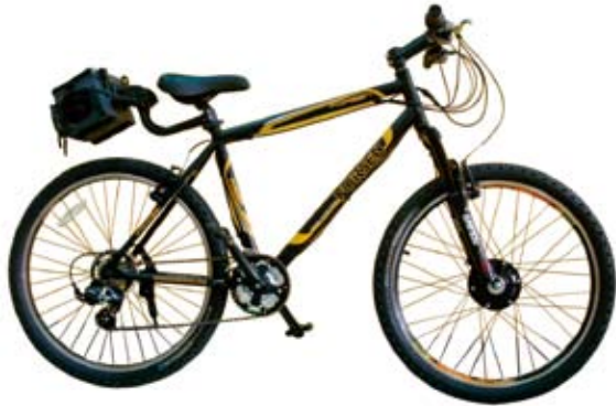
▲卡洛琳Forsen的電動車套件，讓消費者能將任一輛自行車都加裝上電動輔助系統。
