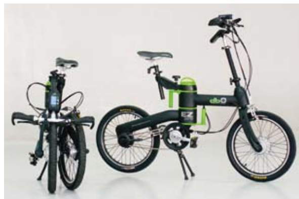
▲db0 電動折疊自行車，採用一體成型車架與專利特殊折疊結構，續航力更達 40 公里，外型相當簡潔、迷人。
