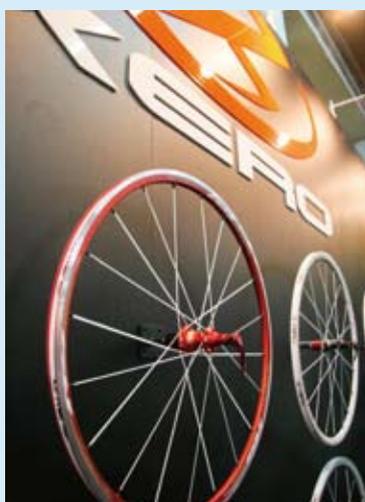
▲XERO展出最新的公路車爬坡用輪組，22mm，以eyelet強化輪圈，並在棘輪端加粗輻條以加強剛性，重1,480g。
