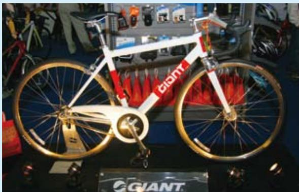
▲Giant復古單速車Bowery72'，車架結合鋼管與鋁合金材質，重8.8kg，售價NT\$16,800。
