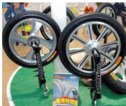
▲正新針對電動車展出「最佳拍檔」，設計前後輪不同的胎紋，符合耐磨與實際需求，經實驗證明可省電10%。
