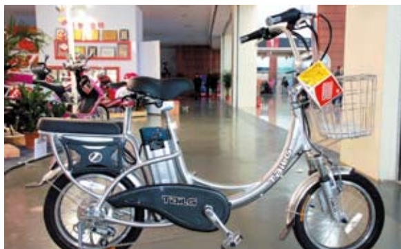
▲台鈴的電動自行車擁有三檔變速，可提供爬坡、經濟和超車等路況。
