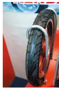
▲KENDA的防刺耐磨王適合電動車使用，採用防刺膠與耐磨膠料。
