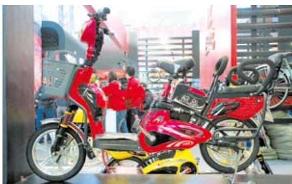
▲藍鳥電動車設計小孩乘坐椅，並有安全帶，前方的快拆式菜籃可載重15kg。
