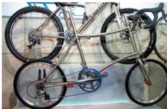
▲藍劍看準鈦合金材質的優點，並彰顯焊工的紋路，針對市場推出小輪徑車。
