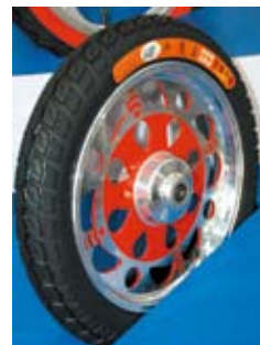
▲INNOVA的牛魔王，將胎肩的膠料移到胎冠，可增加耐磨度，並使用摩托車胎的簾布。
