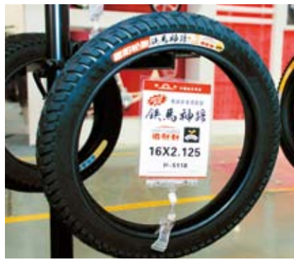
▲朝陽輪胎推出鐵馬神蹄適合電動車使用，主防防刺功能。
