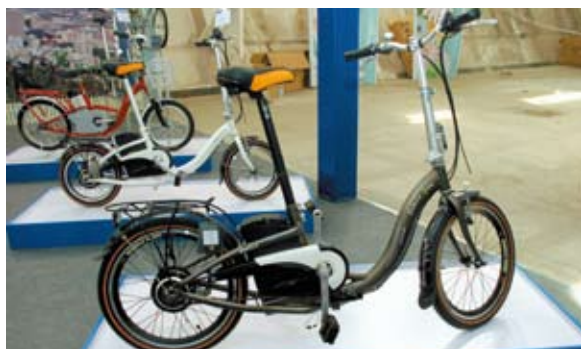
▲DAHON折疊電動車，設計理念強調保留自行車外觀的精神，本款握把可調整角度，座桿還有隱藏式的打氣裝置。
