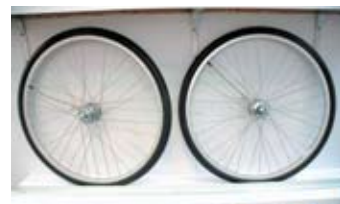
◀鋁光的自動打氣花鼓，通過日本GIS認證，透過不斷地轉動維持氣密度，即便在半路上被刺個小洞，也夠維持到車店維修。
