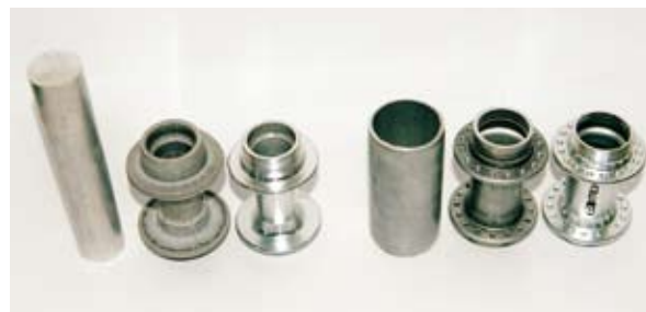
▲左邊是一般花鼓廠的制造方式（鋁條鍛壓）右邊是BITEX的專利制造方式（鋁管制造）。
