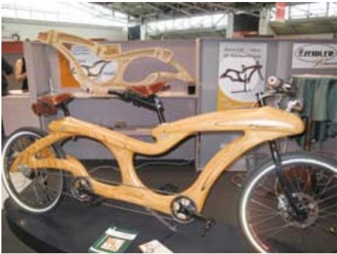
▲ 3D CNC打造的超流線一體成型木製協力車。
