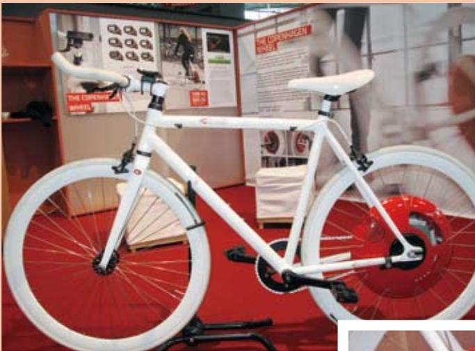
後輪那個紅色的東東，就是傳說中的「哥本哈根輪 (Copenhagen Wheel)」，是由麻省理工學院的 Senseable City 實驗室專為哥本哈根城市所研發設計的，只要將這個圓型的 Copenhagen Wheel 電動套件加裝在自行車後輪，即可變成電動車輕鬆上路！圓型輪裡面整合了電池、GPRS、三段馬達變速系統、環境汙染偵測器、溫度計、基本車表功能等等，還可以透過藍芽設備，與 iPhone 做結合，iPhone 只需放置在車把龍頭正上方，便可隨時偵測環境溫度、污染強度以及噪音品質等周遭環境狀況！此外還有煞車能量回收系統，可將煞車的能量儲存起來，當需要增加速度時再發送出來。
