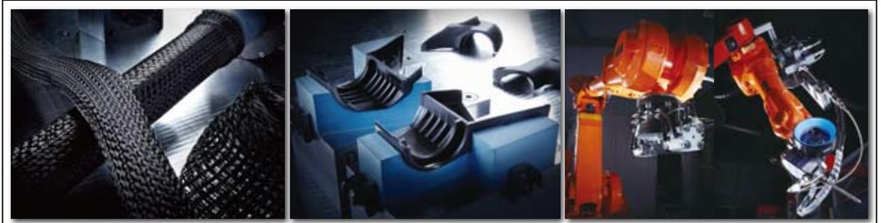
2010年7月初，瑞士頂級自行車品牌BMC邀請全球重量級自行車媒體前往位於瑞士Grenchen的總部，參加BMC革命性創新碳纖維技術的全球首發會暨2011年新車發表與試乘，筆者看到完全顛覆傳統人工疊層打造、品質不一、良率低的碳纖維製程，BMC碳纖維夢工廠impec factory完全採用由電腦以及攝影機精準操控機械人，精確俐落的執行每一個動作與步驟，其100%高品質的尖端科技製程，沒有親眼目睹實在無法想像。
