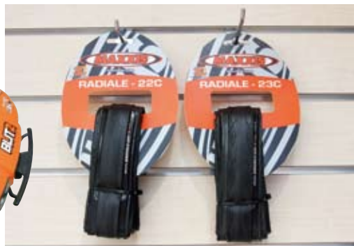
▲正新 (Maxxis) 的Radiale公路車輪胎，可分為22C與23C，前者適用全地形路況，後者適合雨天路況，胎紋設計可提供較佳的排水性，增加轉彎的抓地力。
