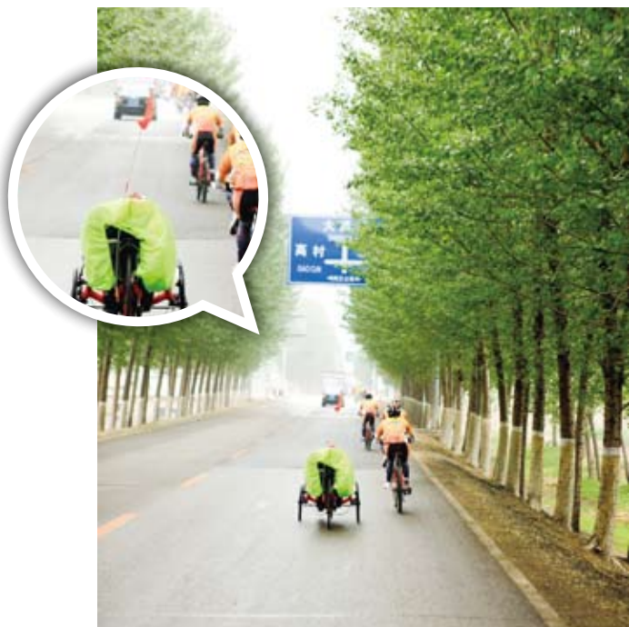
▲由於騎車矮小，為了防止大車在轉彎時看不到，所以插個小旗提示後方車輛。防雨罩也採用顯眼的顏色以發揮安全作用。
