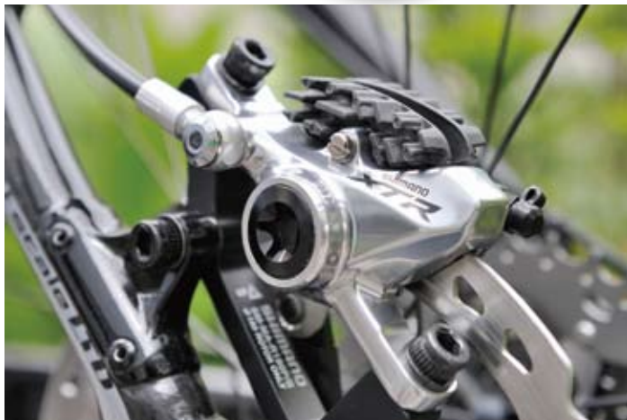
▲全新的魚鱗式散熱片，能將熱量引出卡鉗，並藉由騎乘中的風力帶走。
