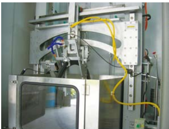
▲環航公司委託機械製造商量身打造的測試機台，可以模擬各種使用路況，有如輪組運轉在天堂路上，測試成果令蔡總經理相當滿意。
