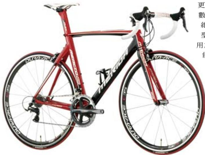
美利達 Reacto 使車架強度更為強韌、但重量卻更輕巧，流線的車架造型於大幅降低風阻係數。極佳的速度感外觀，藉由輕盈的碳纖維布料與特殊的管形幾何設計，水滴式造型能有效降低風阻且增加縱向剛性，也應用於前叉與座管上，而提供較舒適的騎乘性能，另應用美利達早已開發的『雙通道管材』設計在車架上與前叉上，內置肋條的安裝方式可提供特定方向性的高剛性或舒適性。
