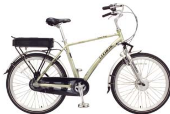
▲LC-TDM-2611A鋰電動車：鋁合金車架，電機250w，電池36v/9ah，最高時速25km，輪胎寬度26×1.95。
